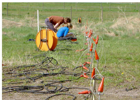
Undersökning av föroreningsutbredning i mark genom så kallad resistivitetsmätning.
